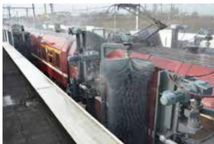
Stations de lavage des trains
