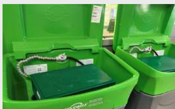
Fontaine de dégraissage biologique
