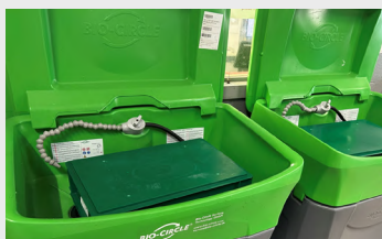
Fontaine de dégraissage biologique
